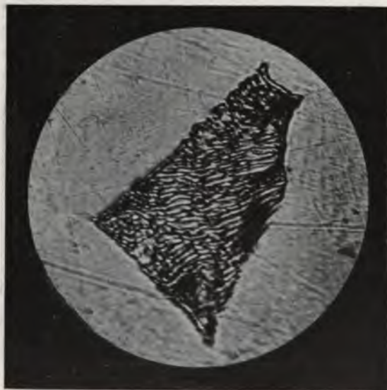
Fig. 135. Material wie Fig. 134. Einzelne Perlitinseln in 1500facher lin. Vergr. umgeben von Ferrit.
